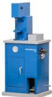
Для установки и удаления заклепок диаметром до 10 мм при замене накладок на тормозных колодках и дисках сцепления. простота использования, высокая скорость, стабильное центрирование, регулируемое усилие клепания. Может использоваться для стальных, алюминиевых и медных заклепок. Работает от сжатого воздуха.
